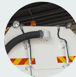
Baliza de peligro, señal acústica y luz de trabajo Hazard beacon, acoustic signal and working light
